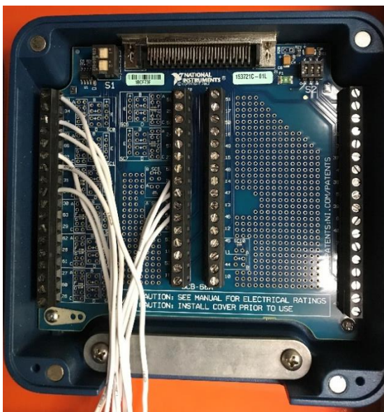
Hình 19 Mô đun giao tiếp của Card PCIe 6323
