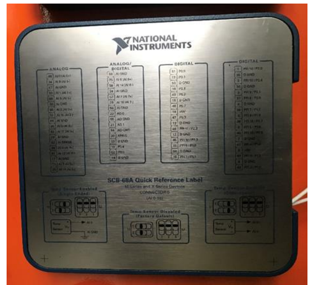
Hình 19 Mô đun giao tiếp của Card PCIe 6323
