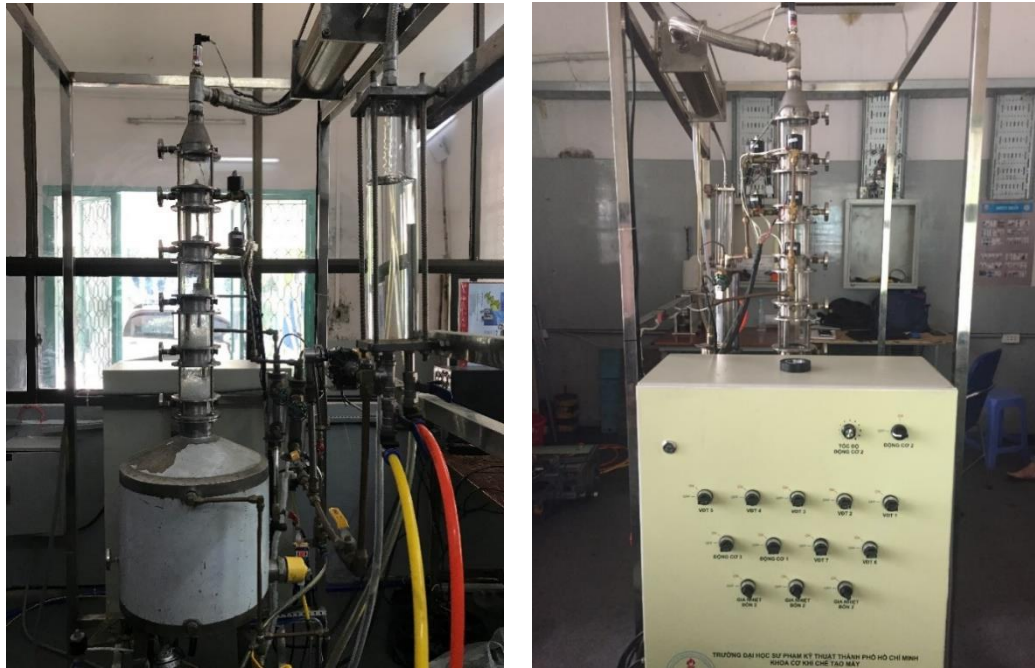
Hình 5.36 Tháp chưng cất sau khi hoàn thiện
