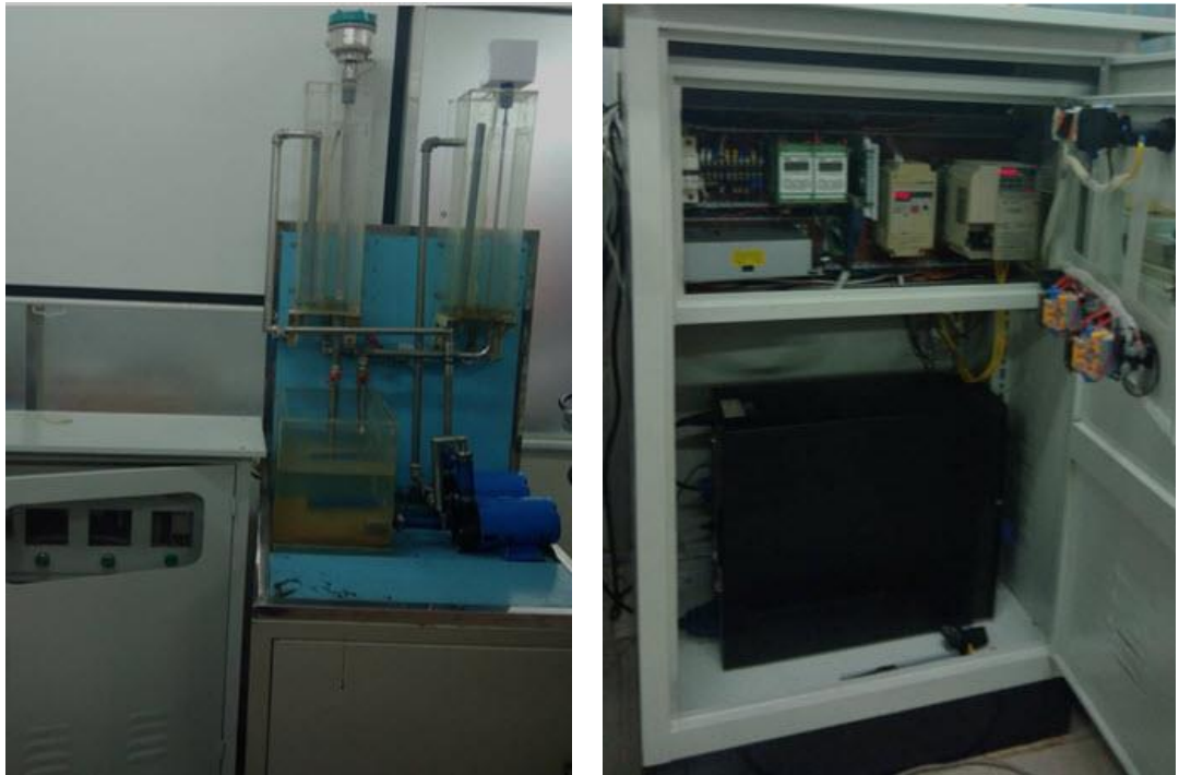
Hình 5.1 Mô hình ứng dụng bồn nước đôi Lưu đồ nguyên lý hoạt động bồn nước được thể hiện ở hình 5.2.
