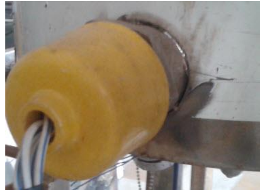
Hình 18 Điện trở gia nhiệt đáy tháp
